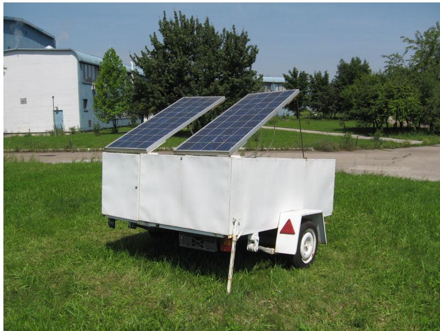
Slika 2 – Solarni fotonaponski paneli postavljeni na prikolici
